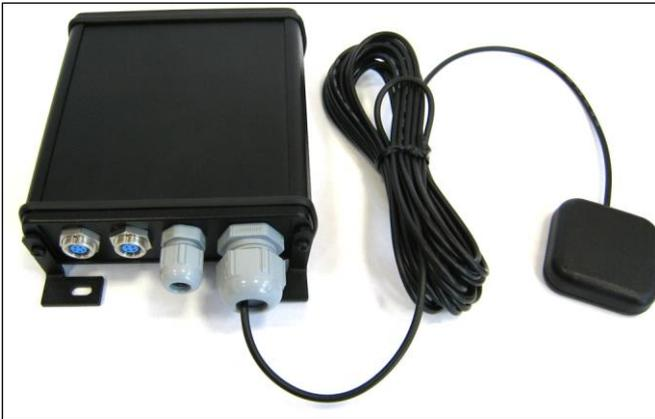
Websat MT ha un apposito connettore per la connessione diretta con l'antenna GPS: vedere foto a lato. Connettere direttamente l'antenna fornita nella confezione all'apposito connettore.
